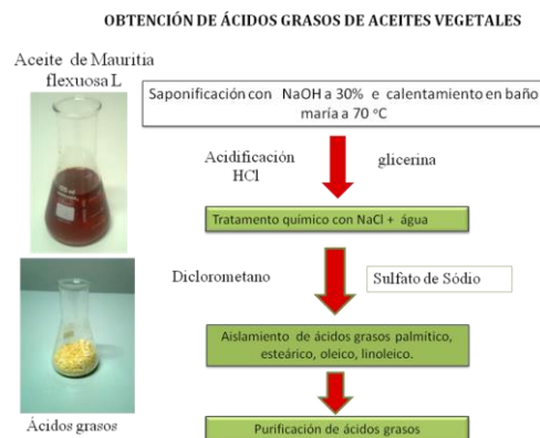
Figura 1: Esquema de obtención de ácidos grasos.
