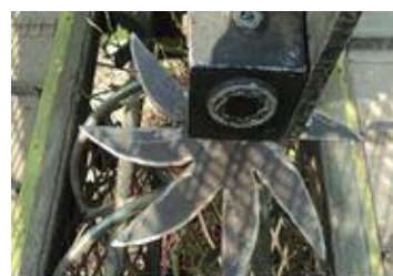
Imagen 22: Fabricación de hélice Horizontal
