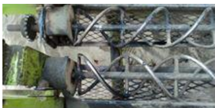
Imagen 25: Soldado de parte Recortada de helicoidales en la prueba N° 03.
