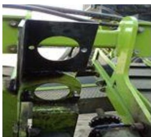
Imagen 27: Levantar motor hidráulico de cabezal de cosecha.
