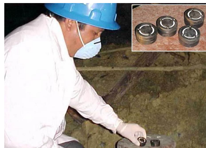
Figura 2: Instalación de dispositivos para radón
